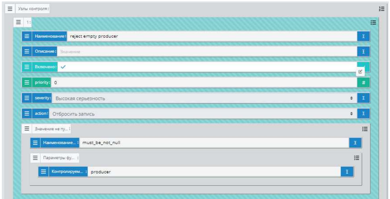
Рисунок 87. Пример узла контроля, использующей функцию «must_be_not_null»
